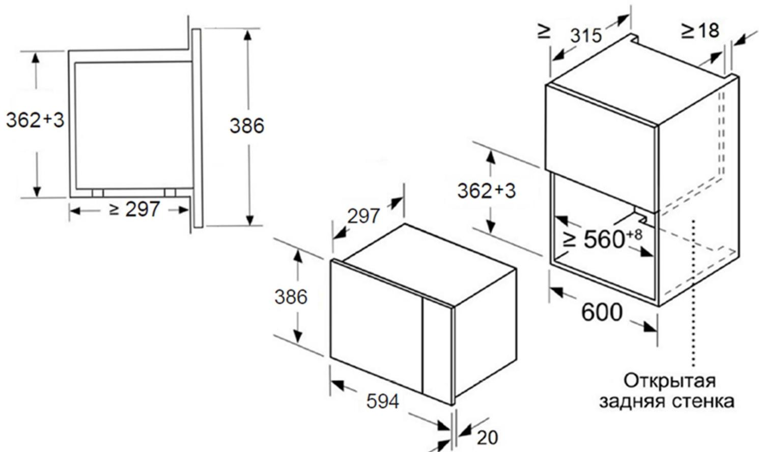
**УСТАНОВКА ПРИБОРА****ВСТРАИВАНИЕ МИКРОВОЛНОВОЙ ПЕЧИ В КОЛОННУ**
