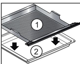
Plaats de geperforeerde roestvrije stalen schaal op de vlakke multifunctionele schaal en voer deze in in het lage niveau 1.
