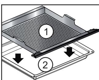
Die perforierte Edelstahlschale auf das Mehrzweckblech legen und in die unterste Einschubleiste 1 schieben.
