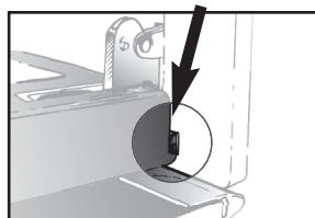
Encaixe o painel apertando-o juntamente com a porta. Não apoiar unicamente sobre o painel.
