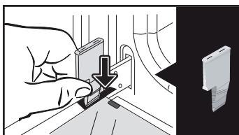
Afin de retirer l'ensemble cadre plus vitre, procédez de la manière suivante: Insérez les deux autres butées dans les emplacements A prévus à cet effet.
