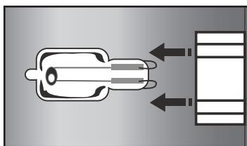
Puede cambiar la bombilla usted mismo cuando deje de funcionar. Desmonte primero el panel de varillas lateral izquierdo.
