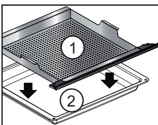
Coloque o prato em inox perfurado sobre o prato multiusos e introduza no encaixe inferior de nível 1.
