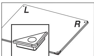
Anschließend diese 2. Scheibe wieder in die Tür einsetzen, indem sie auf die erste Scheibe gelegt wird.
