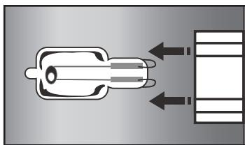
Pode substituir a lâmpada sem ajuda quando deixar de funcionar. Primeiro, desmonte o encaixe lateral esquerdo. A lâmpada pode ser acedida no interior do forno.
