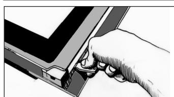
Faites levier sur l'ensemble afin de déclipper le cadre et sa vitre.
