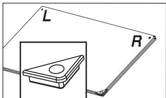
Plaats vervolgens in de deur het tweede glas door het positioneren op het eerste. Vervang uw buitenlijstgeheel en het glas in de deur.
