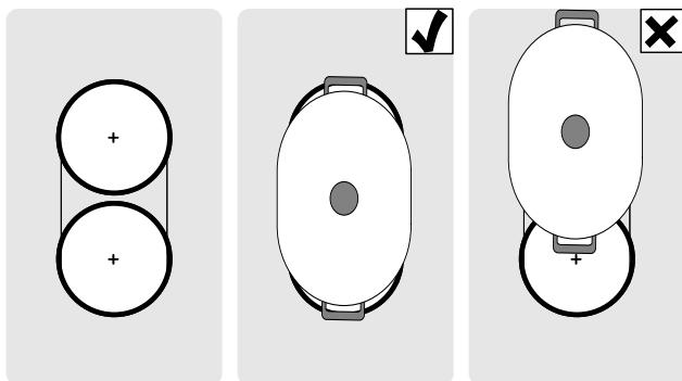
Если вы используете посуду только на одной конфорке, ее можно передвинуть на вторую конфорку. В этом случае степень нагрева конфорки и выбранные установки будут приняты.
