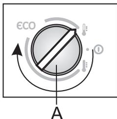
Если температура в помещении, где установлен прибор, ниже +16 °С, рекомендуем установить переключатель **A** в положение
