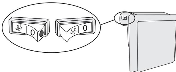
Когда вентилятор включен, на выключателе видна красная точка.
