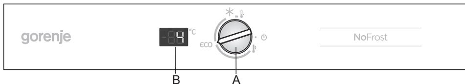
**A** Переключатель ВКЛ./ВЫКЛ. прибора, установки температуры, режима ECO и функции «Быстрое охлаждение и замораживание»
