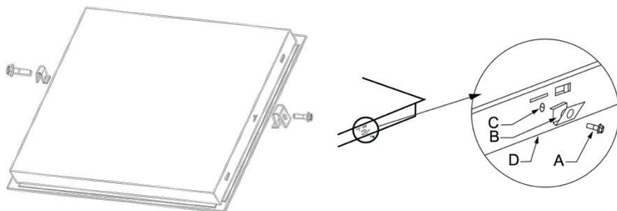
Затем установите варочную панель в вырез столешницы. Слегка надавите на варочную панель, чтобы она вдавилась в столешницу.
