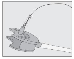
Для удаления остатков молока очищайте корпус промывочного клапана под проточной водой с помощью щёточки.
