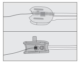
Очистите также подключения для трубок в корпусе промывочного клапана: для этого вставьте щёточку в оба отверстия и двигайте её вперед и назад.
