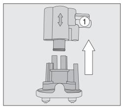
■ Снимите силиконовую деталь с разъёмом для трубки подачи молока ①.
