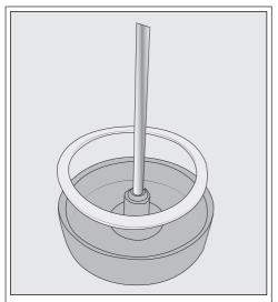
При необходимости вы можете снять соединительный элемент и уплотнительное кольцо с крышки ёмкости для молока. Если вы хотите снять трубку из нержавеющей стали, то слегка выдавите соединительный элемент из внутренней части крышки. Вымойте отдельные детали в посудомоечной машине.
