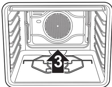
Поставьте на место основание плитки для пиццы, подталкивая его до упора к задней части духовки и давая вклиниться в пластинку нагревательного элемента на основании плиты.
