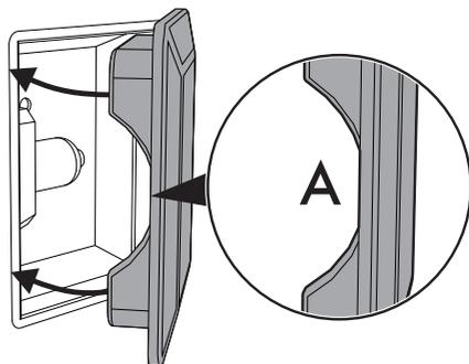
7. Нажмите на крышку таким образом, чтобы она плотно прилегла к патрону лампочки.
