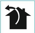
I denne versjonen blir røyk og damp ledet ut i det fri gjennom et avtrekksrør. Til dette formålet, må ventilatorhettens utløpskopling kobles med et rør til en ekstern utgang.
