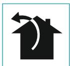
Bij deze uitvoering wordt de geur en de damp via een afvoerbuï naar buiten afgevoerd. Hiervoor dient de motoropening van de afzuigkap dmv een buï aangesloten te worden.
