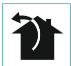
Nessa versão, fumos e vapores são direcionados para o exterior através do tubo de descarga. Para isso, a conexão de saída do exaustor deve estar ligada através de um tubo a uma saída externa.
