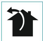
В этой версии дымы и пары выводятся через втягивающий воздухоотвод наружу. Для этой цели выходной патрубок вытяжки должен быть соединен посредством трубы с наружным выходом.
