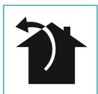
En esta versión, los humos y vapores son canalizados hacia el ambiente exterior a través del tubo de descarga. Para ello, el racor de salida de la campana debe conectarse mediante un tubo, a una salida externa.
