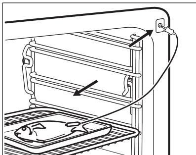
Вставьте наконечник термощупа точно в центр запеканки. Во время запекания термощуп не должен менять своего положения в блюде. Для этого зафиксируйте его при помощи одного из более твердых ингредиентов. Для фиксации силиконовой ручки термощупа воспользуйтесь краем посуды, в которой производится запекание. Наконечник термощупа не должен касаться днища посуды для запекания. Выложите поверх термощупа другие ингредиенты.
