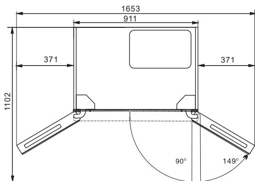
Das in der obigen Abbildung gezeigte Diagramm dient nur zur Installation und stellt kein Bild eines realen Produkts dar. Die spezifischen Abmessungen hängen von dem Modell ab, das Sie gekauft haben.
