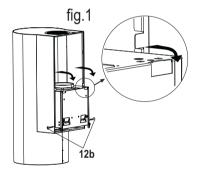
Avvitare il Pezzo pre-inciso con le Staffe (Fig.2) sulla parte superiore del Corpo Cappa, con 2 Viti 12e in dotazione, in modo da bloccare il tubo per l' evacuazione dell'aria.
