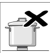
Așezați recipientele pe grătare, niciodată direct pe arzător.
