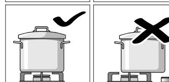
Az edényeket mindenkor középre helyezze. Ellenkező esetben az edény felborulhat. Ne tegyen nagy edényeket azokra az égőkre, amelyek közel vannak a kapcsolókhöz. Ez károkat okozhat a túl magas hőmérséklet miatt.
