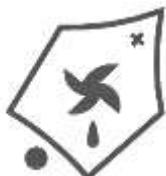
**КОНВЕКЦИОННАЯ РАЗМОРОЗКА:** Данный режим задействует вентилятор, который обдувает замороженное блюдо воздухом комнатной температуры.
