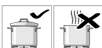
Nu gătiți fără capac sau cu acesta deplasat. Astfel se disipa o parte din energie.
