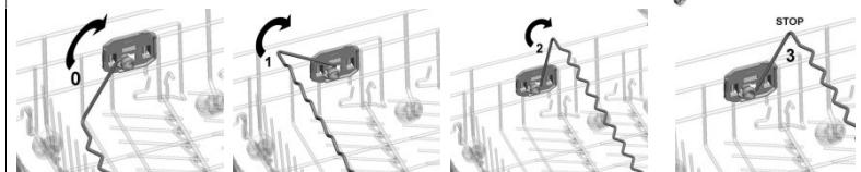
опускающиеся подставки с **2** положениями (1-2). В положении **1** (вертикальном) используются для поддержания тарелок, в положении **2** (наклонном) поддерживают бокалы на длинной ножке, которые упираются в **держатель для стаканов**. Регулировка: поднимите деталь **P**, как показывается, до тех пор, пока подставка не займет положение **2**.
