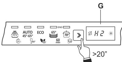
Если после выполнения регулировки или просмотра заданного значения не касаться кнопки в течение нескольких секунд, посудомоечная машина автоматически выйдет из режима регулировки и вернется в стандартный режим работы.
