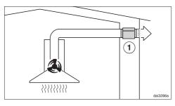
В режиме отвода воздуха шумоподавитель уменьшает звук работающего вентилятора, а также внешние шумы, которые могут проникать на кухню через воздуховод (например, шум улицы). Для этого шумоподавитель должен располагаться перед выходным отверстием воздуховода ①, как можно ближе к нему.
