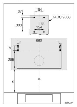
■ Если сначала изготавливается задняя стенка, в которой должны быть отверстия для крепления, то необходимо соблюдать указанные на плане промежутки между отверстиями (шурупы Ø 5 мм).
