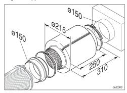
Для дополнительной звукоизоляции в воздуховоде можно установить шумоподавитель (дополнительно приобретаемая принадлежность).
