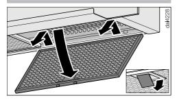
■ Ослабить фиксатор фильтра, наклонить фильтр примерно на 45° вниз, вывести из паза и снять.
