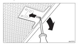
■ Если фильтры были случайно установлены наоборот: разблокируйте фиксатор через выемки с помощью небольшой отвертки.
