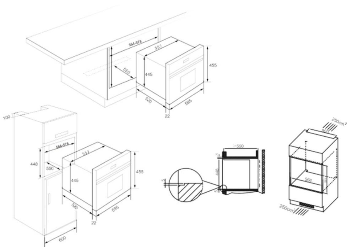
Откройте дверцу духового шкафа и закрепите устройство с помощью 4 саморезов, как показано на схеме ниже.
