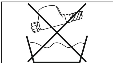
**Не погружайте защитный корпус электромагнитных клапанов шланга залива воды в жидкость.**
