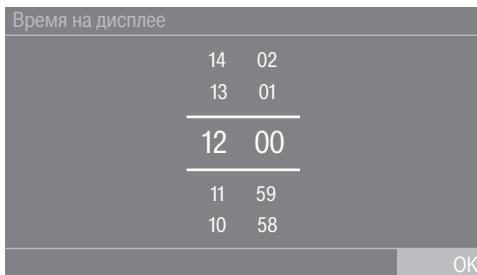
Введите числа, проводя пальцем по дисплею вверх или вниз. Положите палец на цифру, которую нужно изменить, и проведите им в нужном направлении. Используйте сенсорную кнопку *OK*, чтобы принять введённые настройки.
