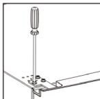
16. Соедините проводку двери и холодильника. Затем замените верхнюю защитную крышку. Перед завинчиванием крышки подсоедините клеммы дверного переключателя.
