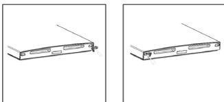
13. Отсоедините изоляцию дверцы холодильной и морозильной камеры, а затем переверните и закрепите обратно.
