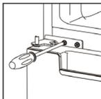
15. Установите верхнюю дверь, проверьте, чтобы уплотнитель двери плотно прилегал к холодильнику. После этого зафиксируйте дверь верхней петлей.
