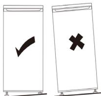
При установке необходимо выравнивать прибор относительно горизонтального уровня. Если холодильник установлен не по уровню, магнитные уплотнители дверей будут закрываться не плотно.
