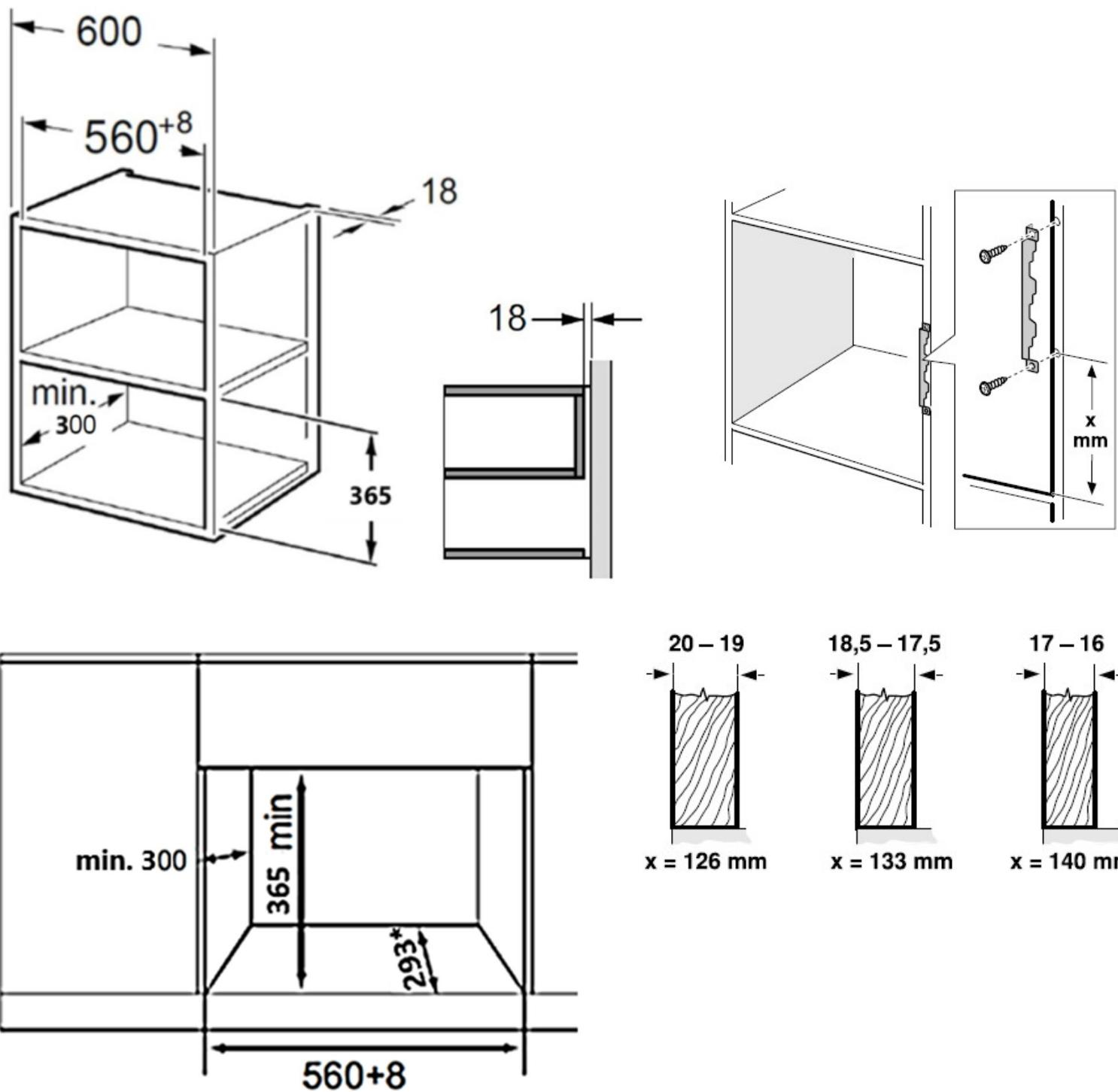
\* - глубина СВЧ-печи без учета наконечника кабеля, предохраняющего кабель от излома.
